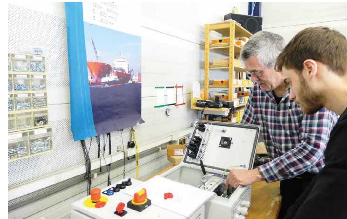
Henk Hartholt (l) en een paneelbouwer bij de besturingsunit voor een ankerlier. Foto Willem de Niet
